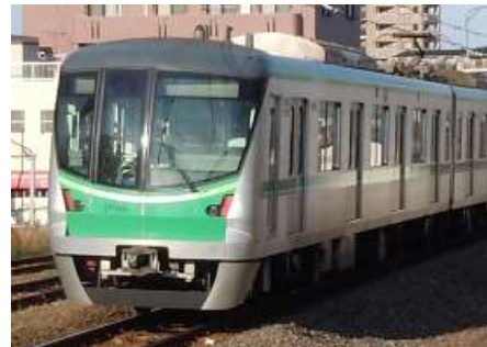
図 1.2 16000 系電車 (東京メトロ・永久磁石同期電動機)
